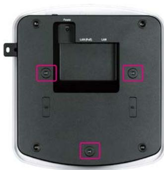
6. マウントプレートにある 3 箇所の溝に手順 5 でとりつけたネジを合わせ、スライドさせて取り付けます。
