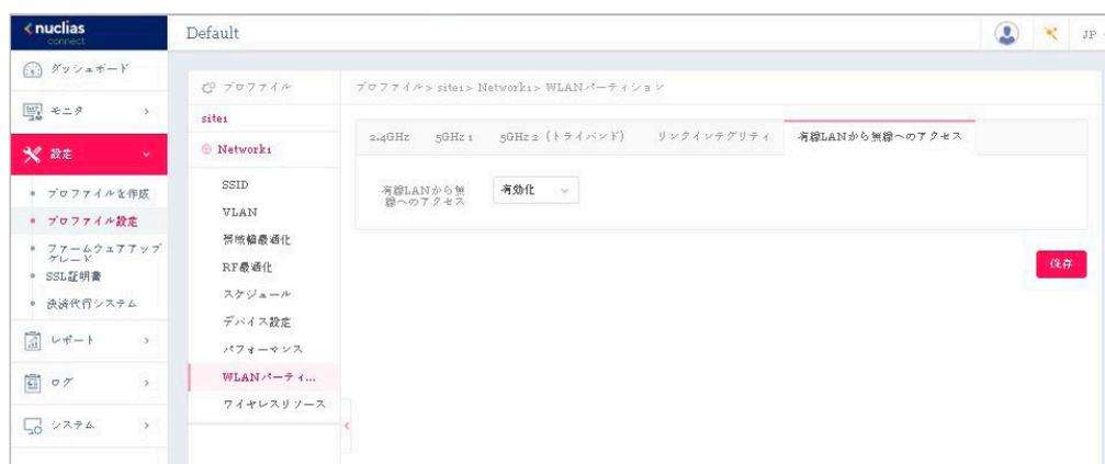
図 1-25 プロファイル設定 - WLAN パーティション (有線 LAN から無線へのアクセス)
