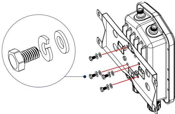
図 3-34 DBA-3621P マウントプレートの取り付け
