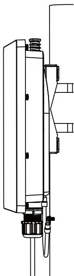
図 3-38 DBA-3621P アース線の取り付け
