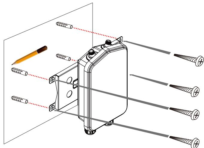
図 3-35 DBA-3621P 壁への取り付け
