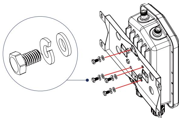
図 3-34 DBA-3621P マウントプレートの取り付け
