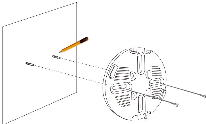
図 3-39 DBA-X2830P 天井または壁面への設置
