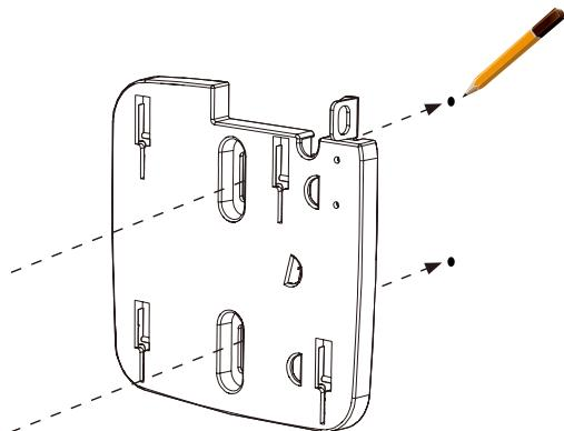
図 3-6 DBA-1210P 位置確認（壁面設置）
