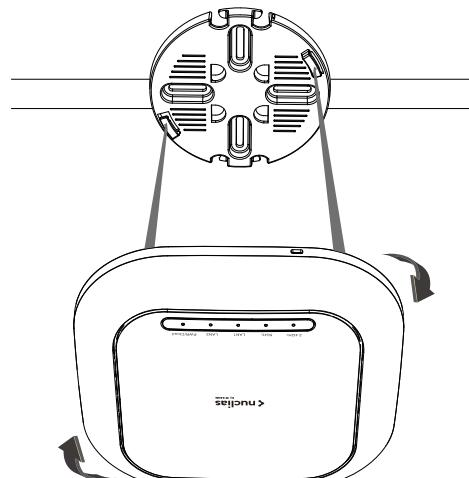
図 3-24 DBA-2720P マウントプレートへの取り付け
