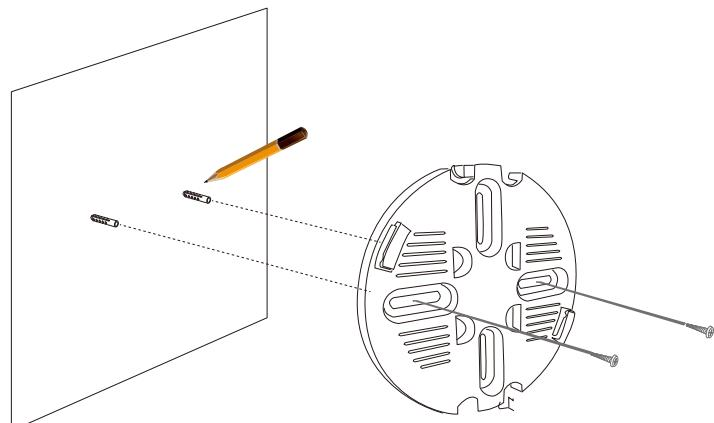
図 3-11 DBA-2520P 天井または壁面への設置
