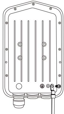
図 3-36 DBA-3621P アース線の接続
