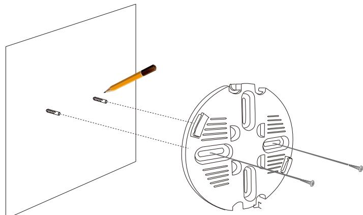
図 3-21 DBA-2720P 天井または壁面への設置
