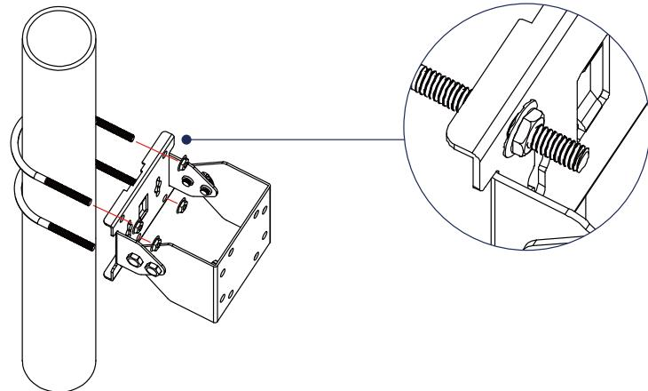
図 3-32 DBA-3621P 柱への設置
