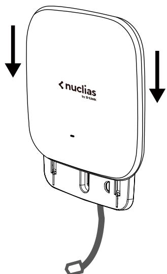
図 3-9 DBA-1210P 機器の設置
