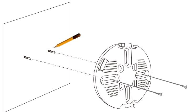
図 3-44 DBA-X1230P マウントプレートの取り付け
