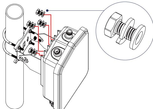
図 3-33 DBA-3621P 柱用マウントプレートへの取り付け
