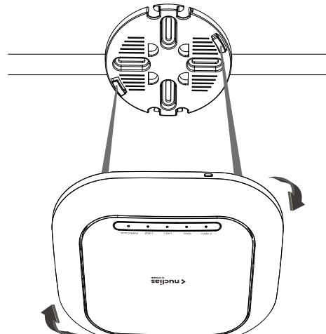
図 3-42 DBA-X2830P マウントプレートへの取り付け
