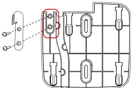
図 3-5 DBA-1210P セキュリティ金具の取り付け
