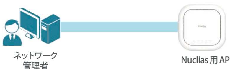
図 3-2 接続方法（直接接続）
