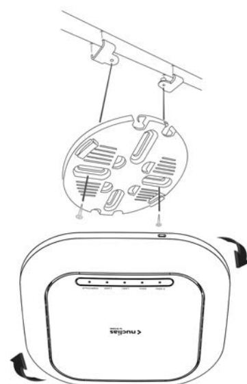
図 3-17 DBA-2620P 天井クロスバーへの設置
