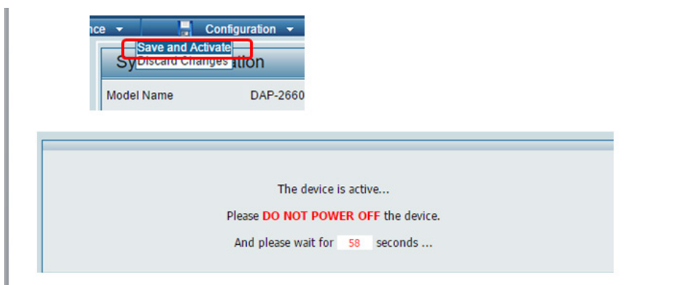
図 8-16 Save and Activate (設定の有効化) (DAP-2660)
