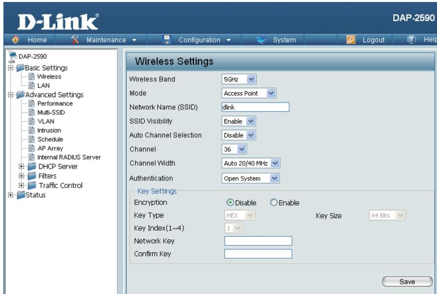
図 4-5 Wireless Settings (Open System) 画面
