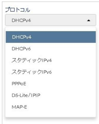
図 10-12 プロトコルの選択
