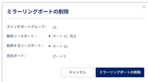
図 9-10 ミラーリングポートの削除
