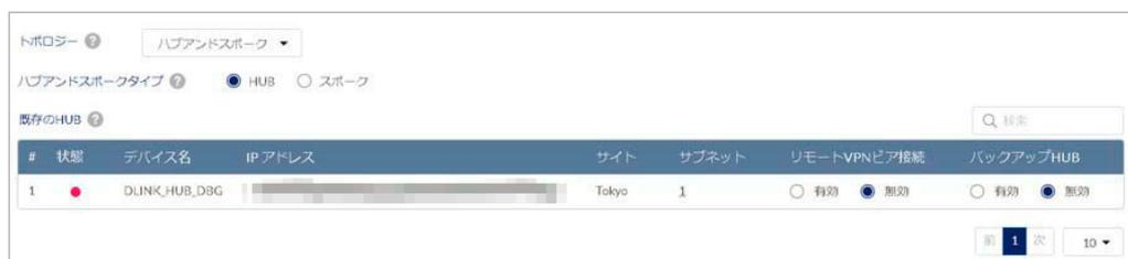
図 10-76 SITE TO SITE VPN 設定 (ハブアンドスポーク - HUB 選択時)
