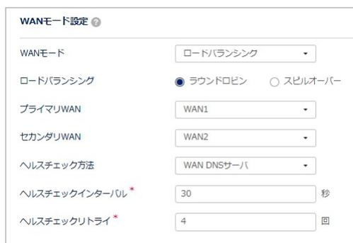
図 10-17 ロードバランシング (ラウンドロビン)
