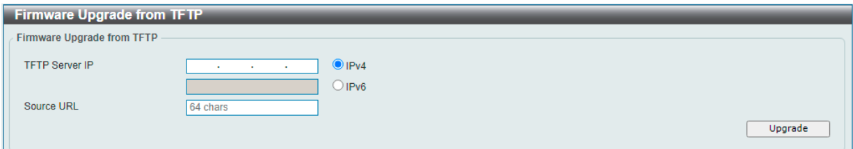
図 16-6 Firmware Upgrade from TFTP 画面
