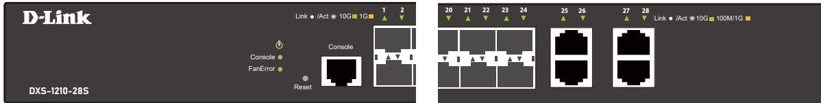
図 1-3 DXS-1210-28T/28S の LED 配置図
