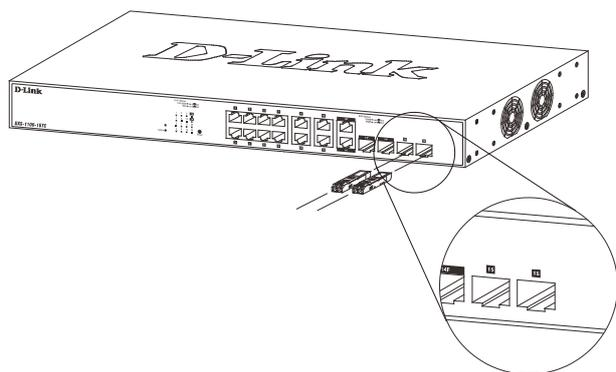
図 2-5 SFP ポートにモジュールを挿入
