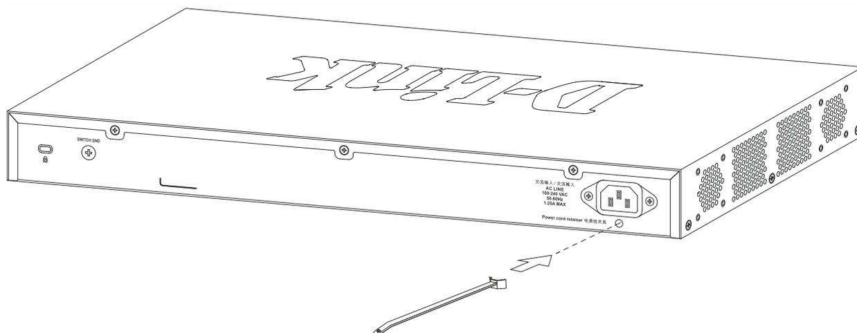
図 2-6 タイラップの挿し込み
