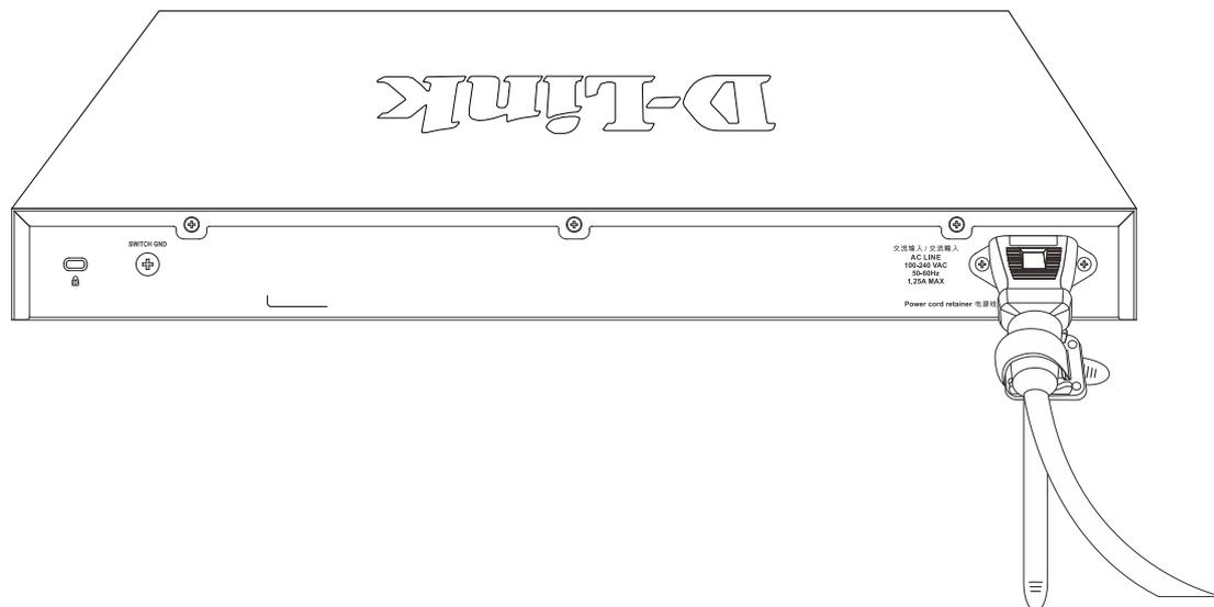
図 2-10 電源抜け防止クリップの固定確認
