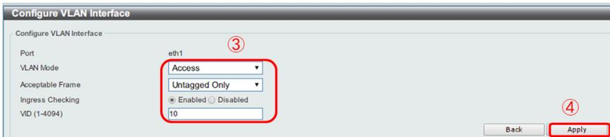
図 1-8 VLAN インタフェース設定 (ポート 1) (DXS-1100-10TS)
