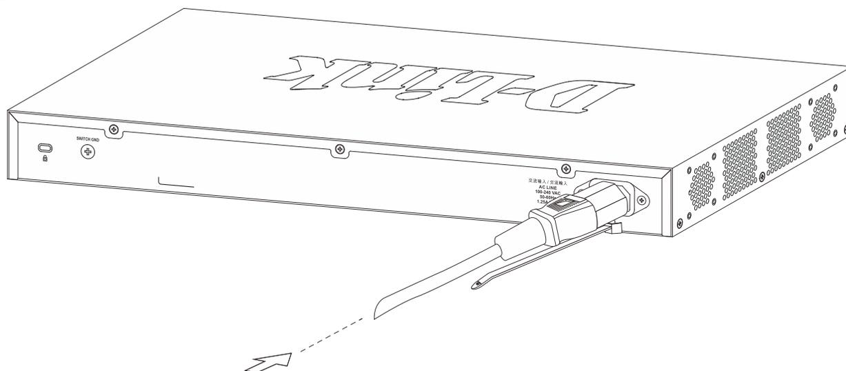
図 2-7 電源コード挿し込み
