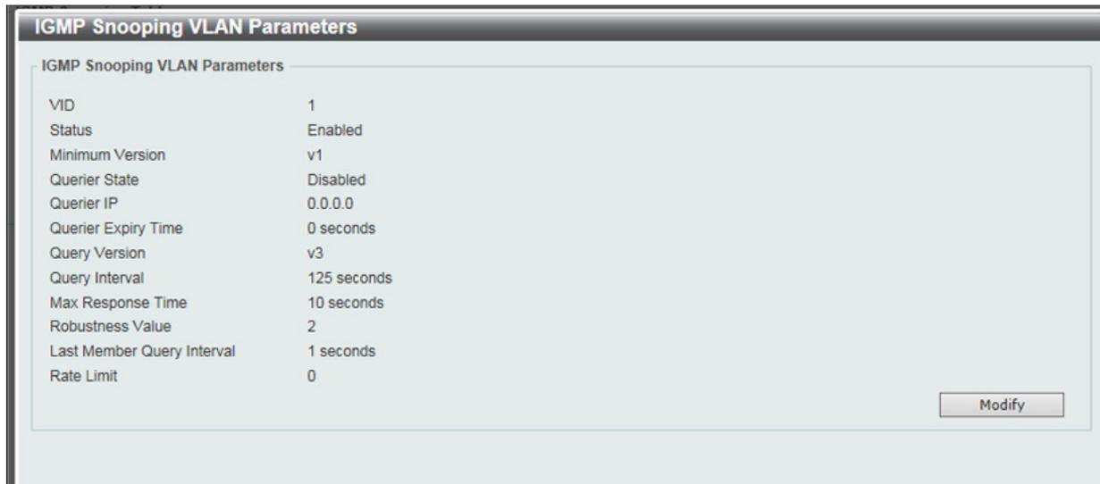
図 8-31 IGMP Snooping VLAN Parameters 画面
