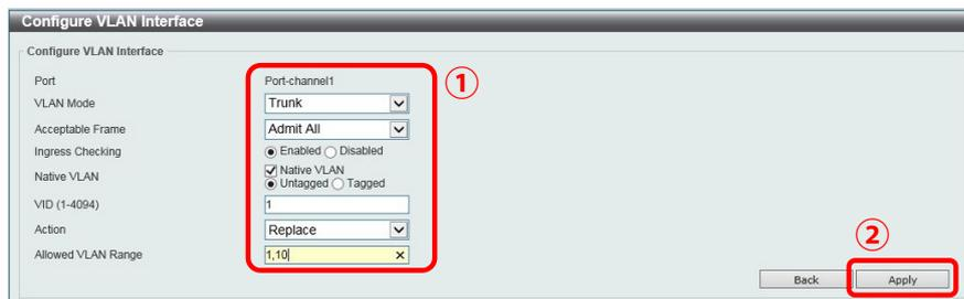
図 1-15 VLAN インタフェース設定 (Port-channel1) (DXS-1100-16TC)
