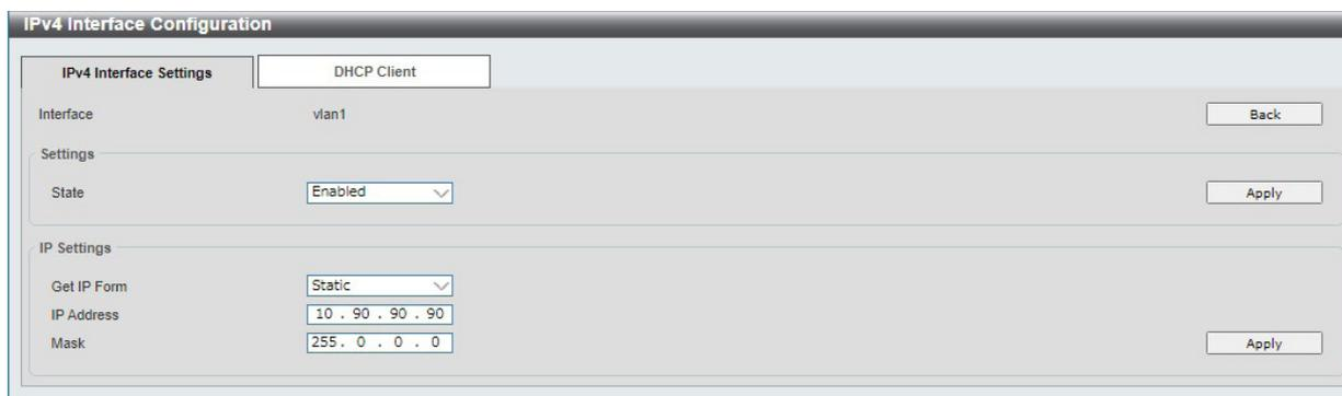
図 9-5 IPv4 Interface Configure - IPv4 Interface Settings 画面
