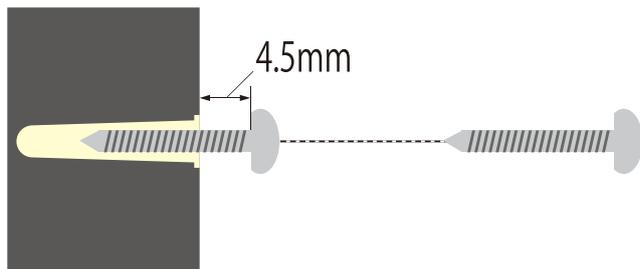
図 2-7 ネジの挿し込み
