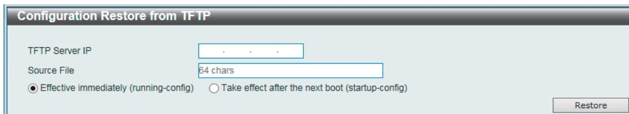
図 14-9 Configuration Restore from TFTP 画面
