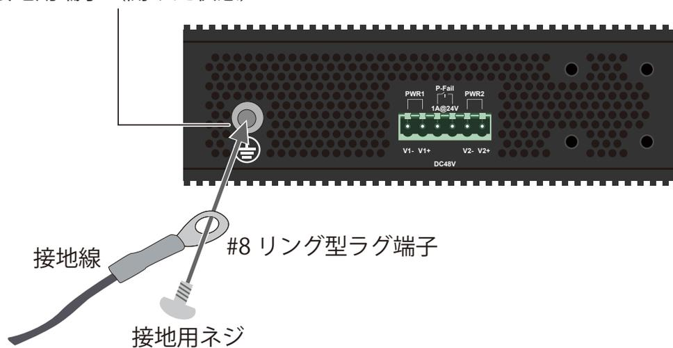
図 2-10 スwitchへのラグ端子の接地
