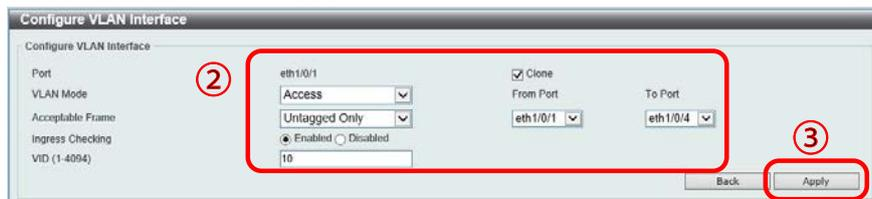
図 16-8 VLAN インタフェース設定 (ポート 1-4) (DIS-200G-12PSW)
