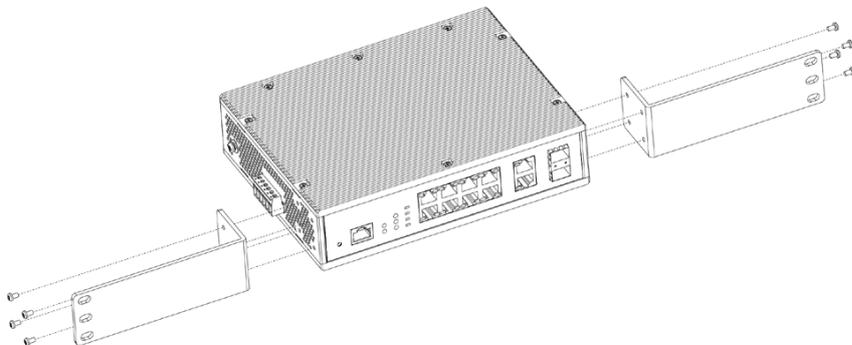
図 2-8 スイッチへのブラケットの取り付け
