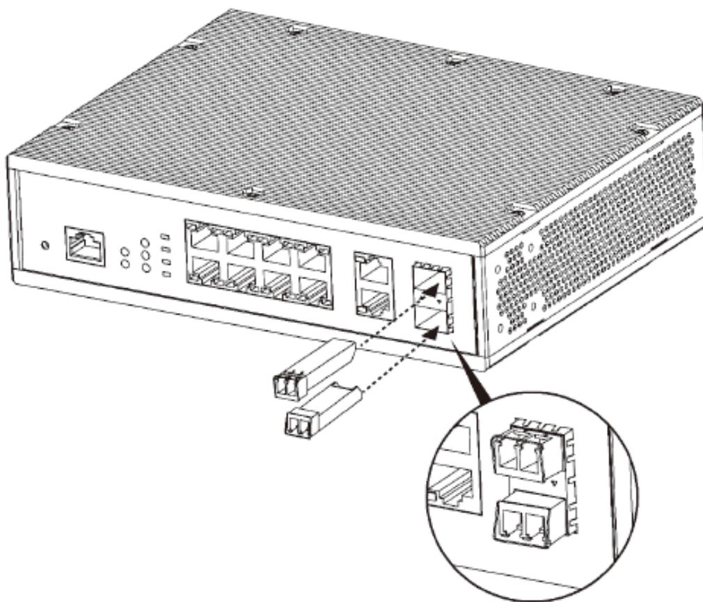
図 2-11 SFP モジュールの取り付け
