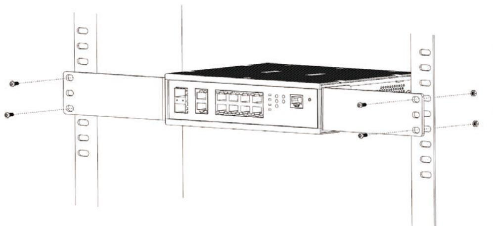
図 2-9 スイッチのラックへの設置
