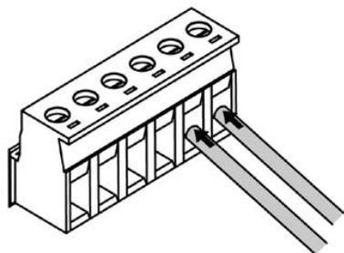
図 2-16 DC 電源ケーブル挿し込み
