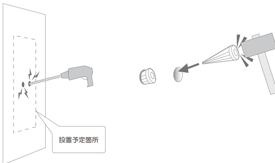
図 2-6 壁面への穴あけ、アンカー挿し込み
