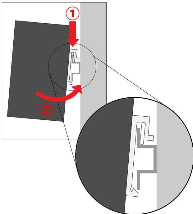
図 2-1 DIN レールへの設置
