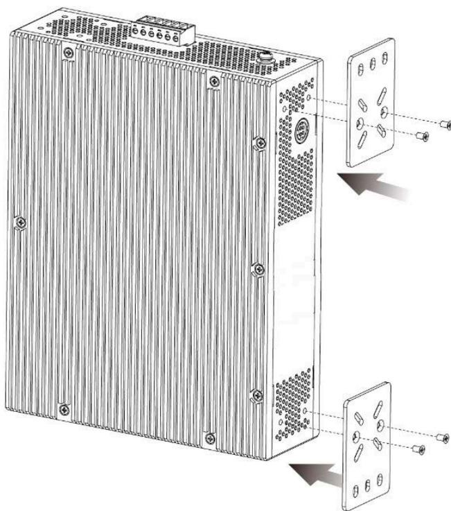
図 2-3 壁面取り付けプレートの取り付け
