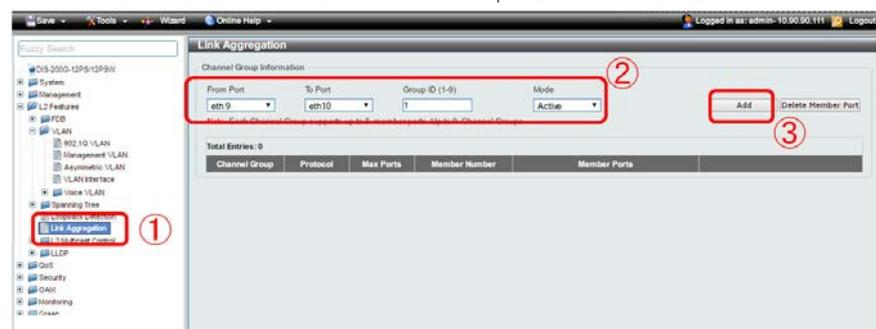
図 16-15 Link Aggregation 設定（ポート 9-10）（DIS-200G-12PSW）
