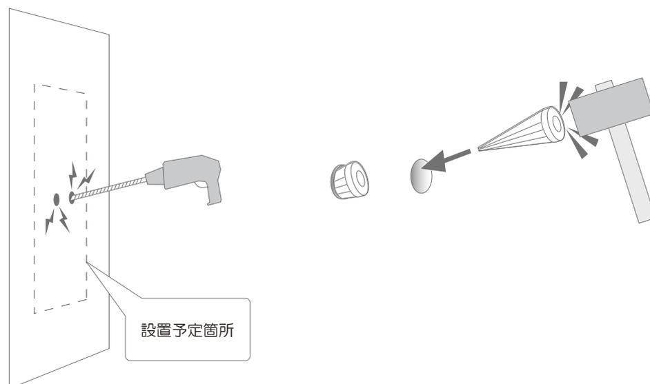
図 2-4 壁面への穴あけ、アンカー挿し込み
