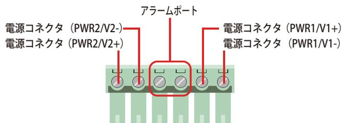
図 2-15 DC ターミナルブロックの接続端子部のネジと対応するコネクタ / ポート
