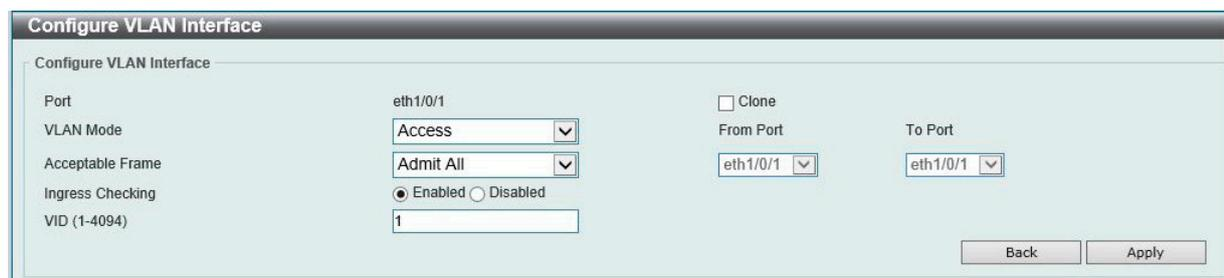
図 8-17 Configure VLAN Interface - Access 画面
