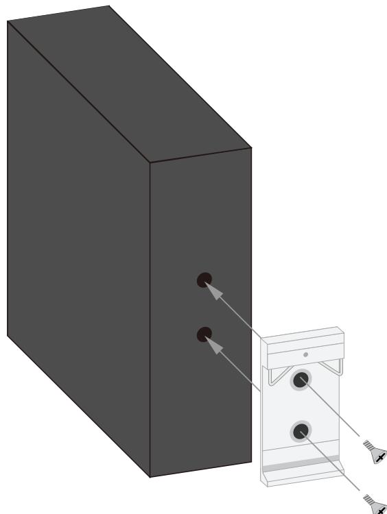
図 2-1 DIN レールブラケットの取り付け
