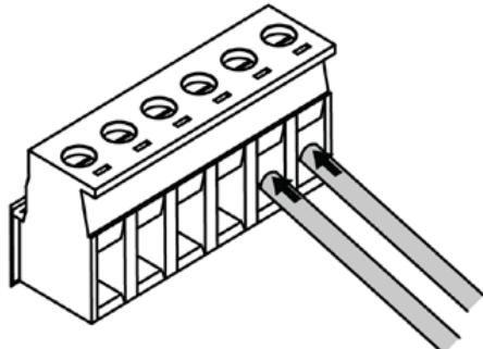
図2-13 DC電源ケーブル挿し込み
