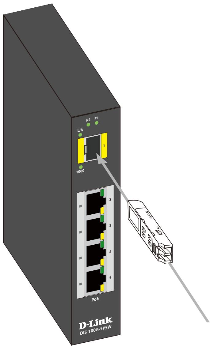
図 2-9 SFP モジュールの取り付け
