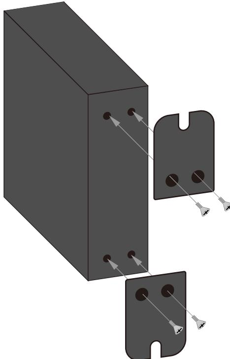
図 2-4 壁面取り付けプレートの取り付け
