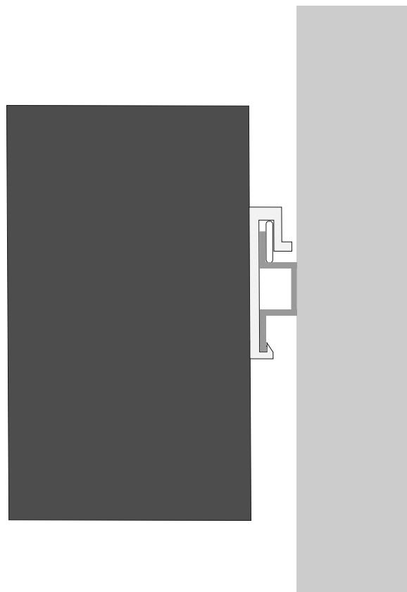
図 2-3 DIN レールへの設置確認
