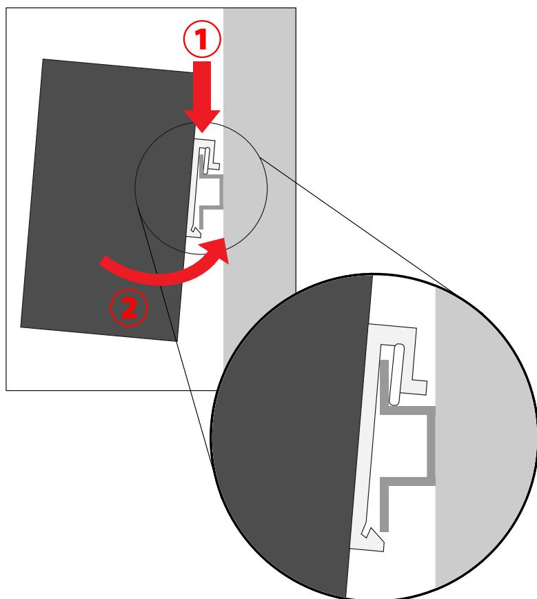
図 2-2 DIN レールへの設置
