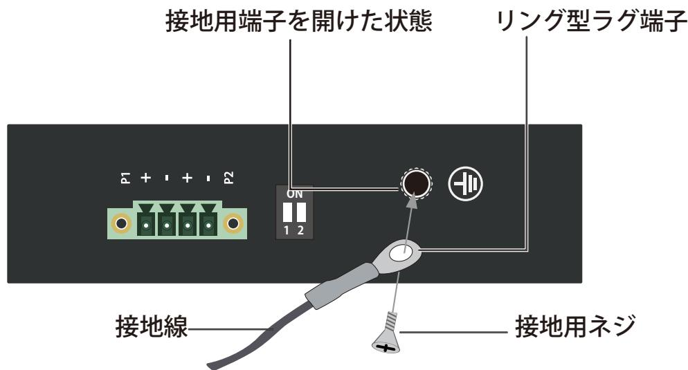
図 2-7 スイッチへのラグ端子の接地
