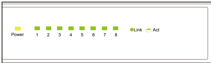
図 1-5 DES-1008I/RM の LED 配置図
