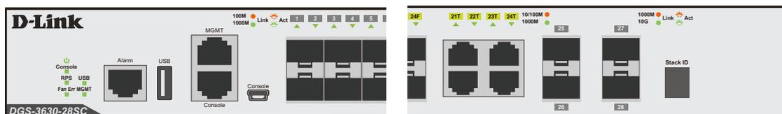
図 3-8 DGS-3630-28SC の前面パネル LED 配置図
