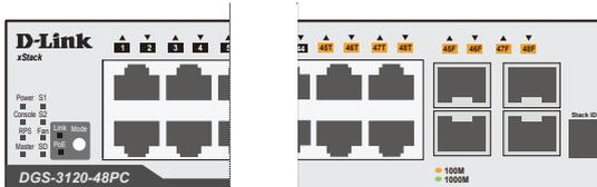
図 1-10 DGS-3120-48PC の LED 配置図
