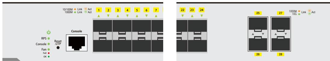
図 1-16 DGS-3000-28XS の LED パネル
