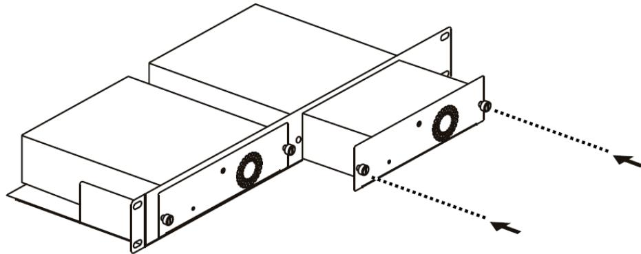
図 2-13 DPS-800 に DPS-500A を取り付ける
