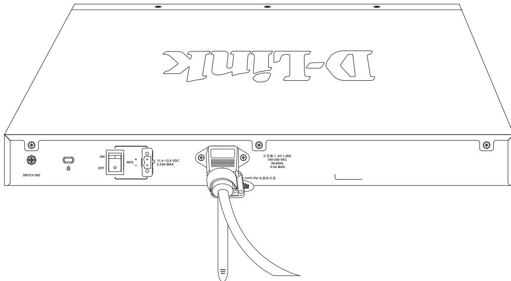
図 2-9 電源抜け防止器具の固定確認
