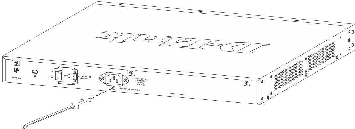
図 2-5 タイラップの挿し込み
