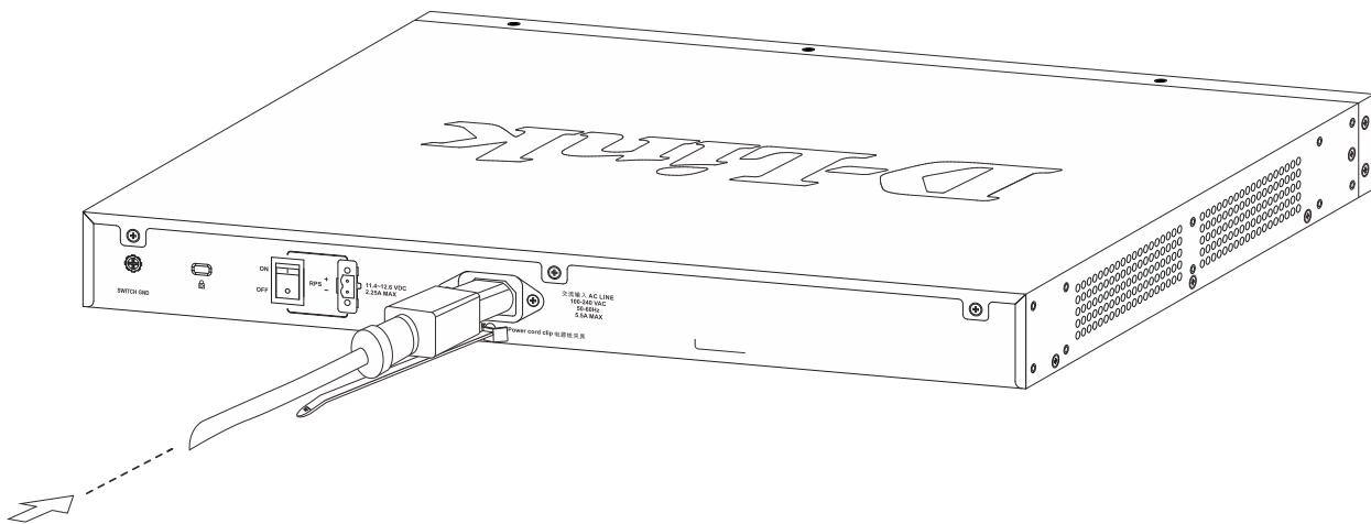
図 2-6 電源コード挿し込み
