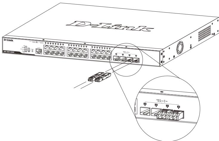
図 2-10 SFP ポートにモジュールを挿入
