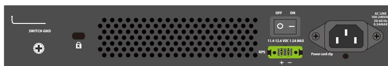
図 1-19 DGS-3000-10L/20L の背面パネル
