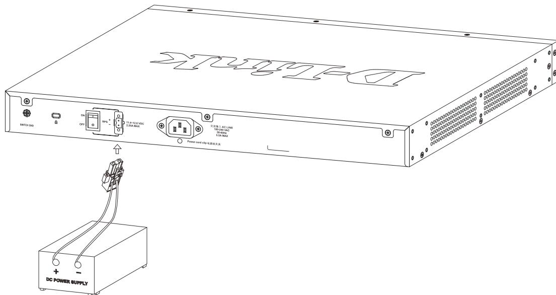
図 2-4 外部 DC 電源の端子盤への接続
