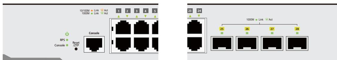
図 1-12 DGS-3000-28L の LED パネル
