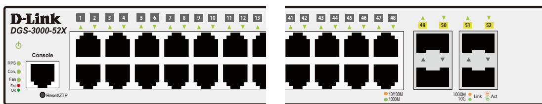
図 1-18 DGS-3000-52X の LED パネル
