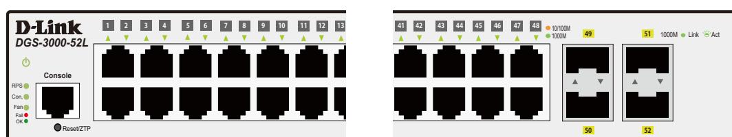
図 1-14 DGS-3000-52L の LED パネル
