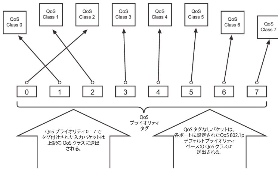
図 10-1 スイッチ上の QoS マッピングの例
