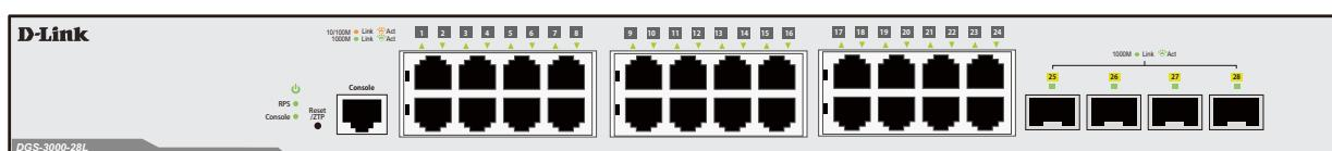
図 1-3 DGS-3000-28L の前面パネル
