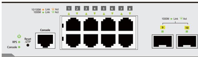
図 1-10 DGS-3000-10L の LED パネル
