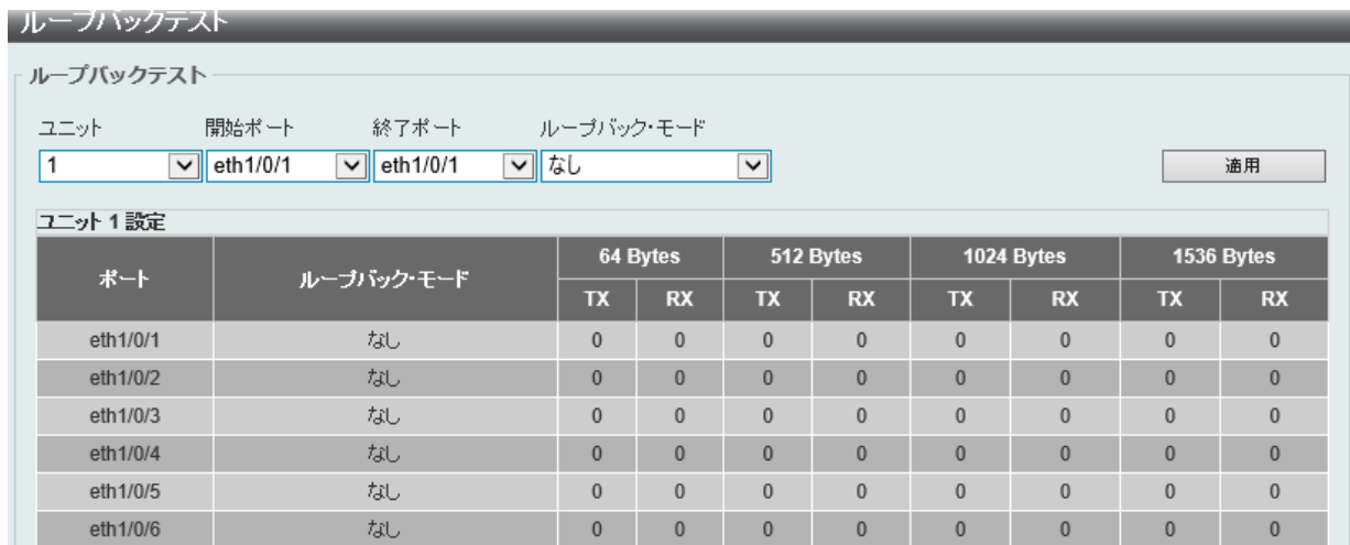
図 6-11 ループバックテスト画面
