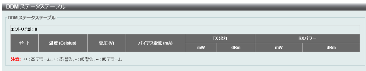
図 13-8 DDM ステータステーブル画面
