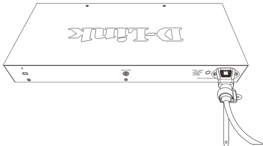
図 2-9 電源抜け防止クリップの固定確認
