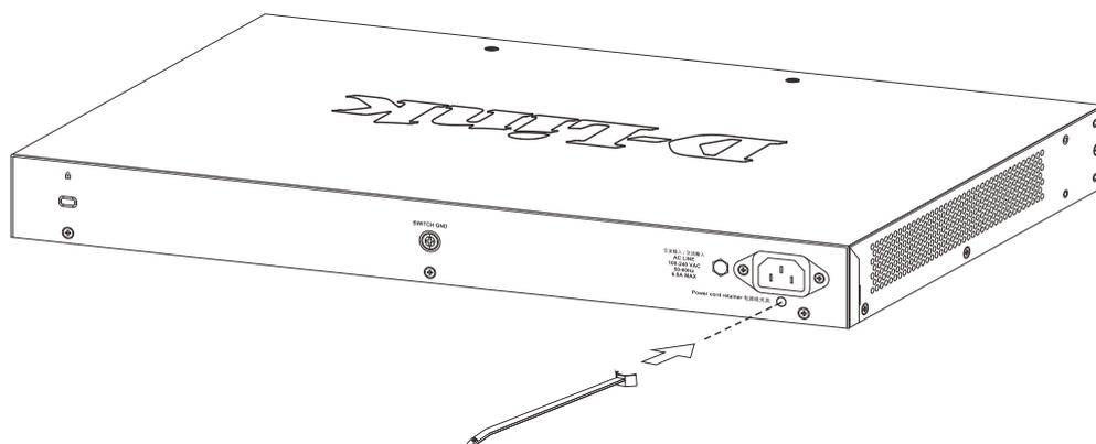
図 2-5 タイラップの挿し込み
