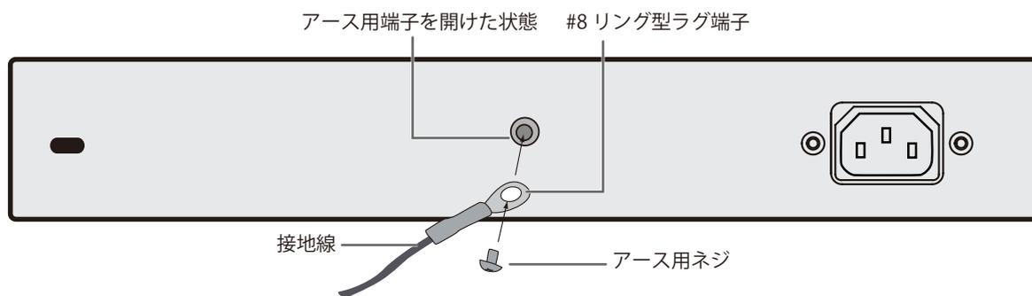
図 2-10 スイッチへのラグ端子の接続
