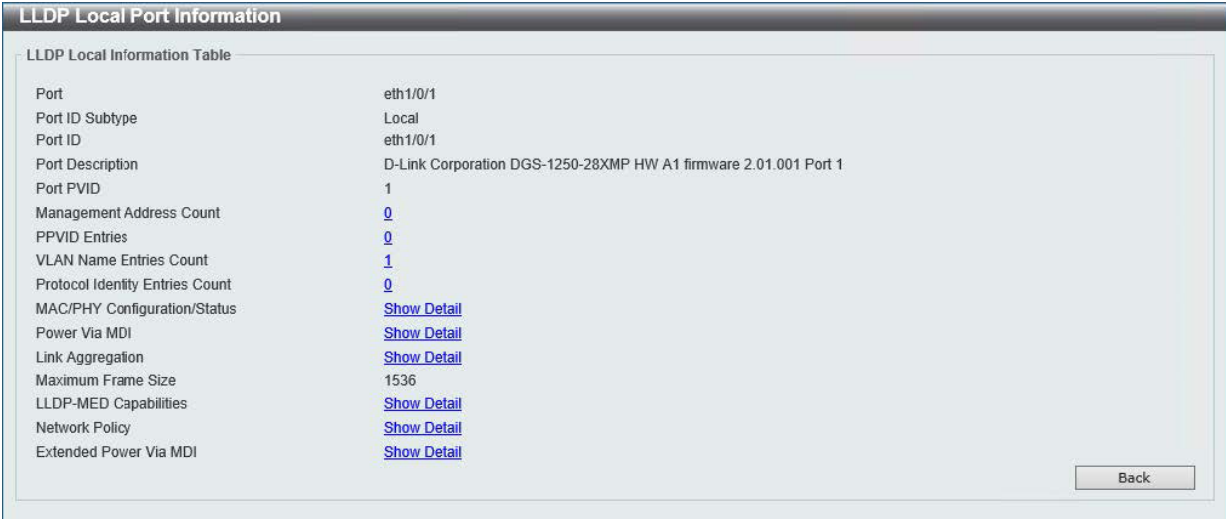
図 8-65 LLDP Local Port Information (Show Detail) 画面
