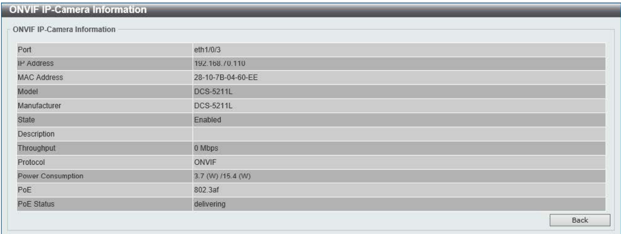
図 8-23 ONVIF IP-Camera Information (More Detail) 画面
