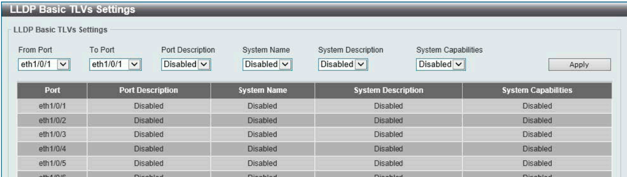
図 8-59 LLDP Basic TLVs Settings 画面
