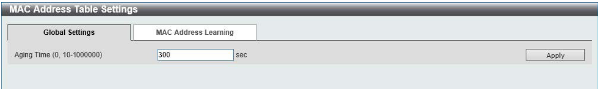
図 8-2 MAC Address Table Settings - Global Settings 画面
