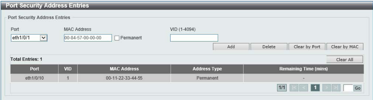
図 12-3 Port Security Address Entries 画面
