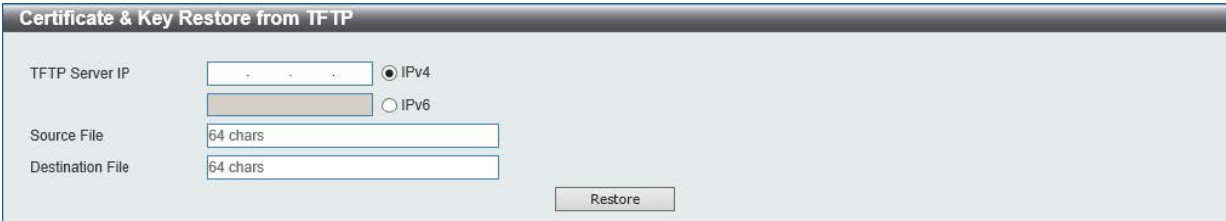
図 16-12 Certificate & Key Restore from TFTP 画面
