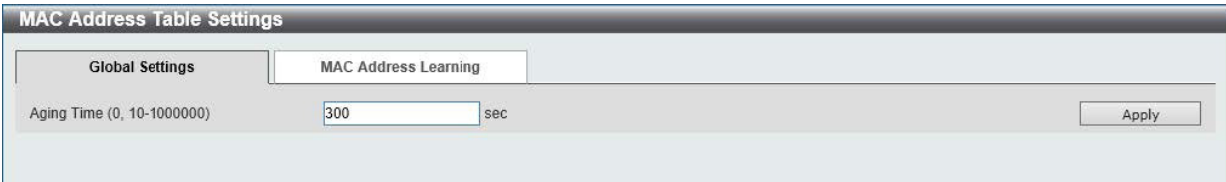
図 8-3 MAC Address Table Settings - Global Settings 画面
