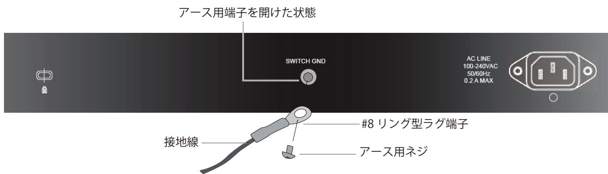
図 2-9 スイッチへのラグ端子の接続
