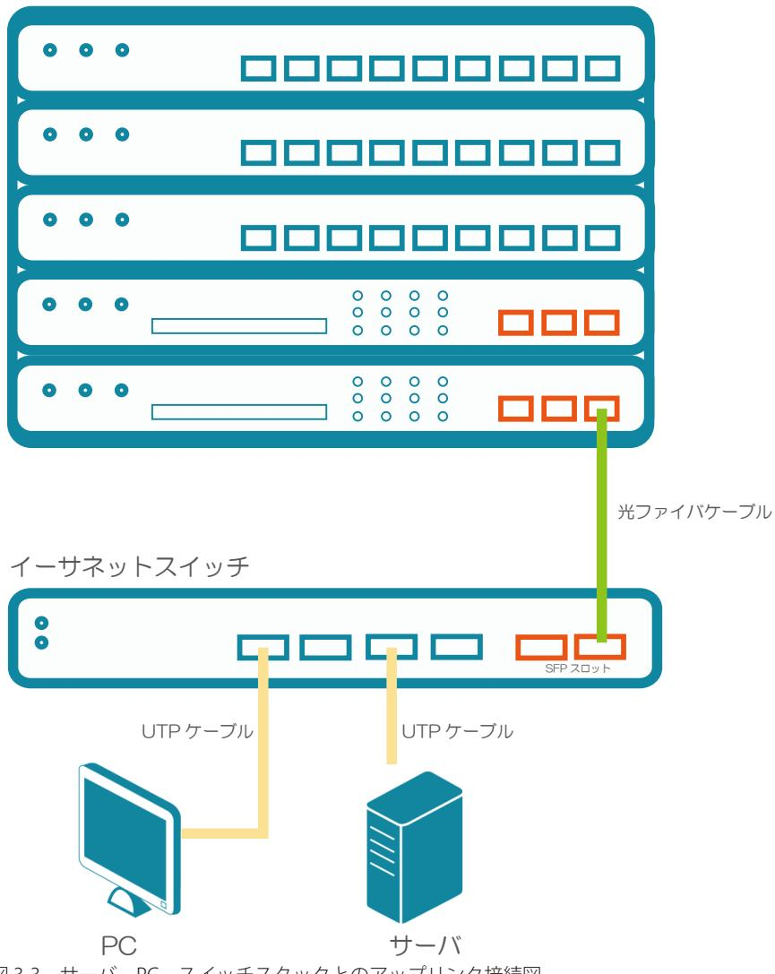
図 3-3 サーバ、PC、スイッチスタックとのアップリンク接続図
