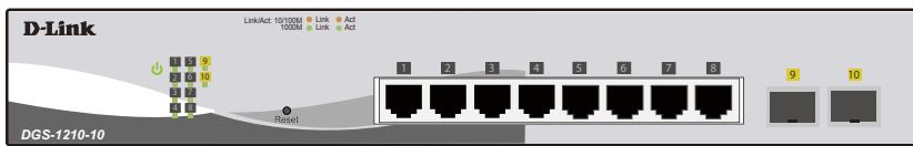
図 1-1 DGS-1210-10 の前面パネル図
