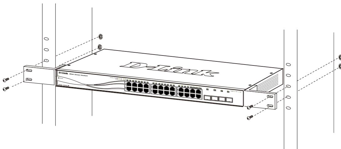
図2-3 スイッチのラックへの設置
