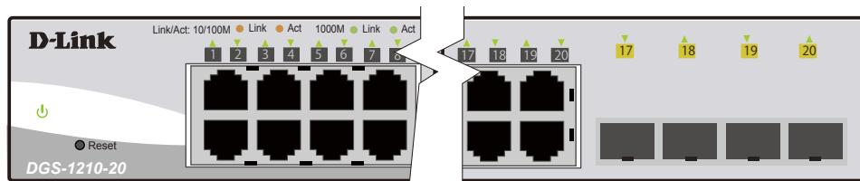
図 1-8 DGS-1210-20 の前面パネルの LED 配置図
