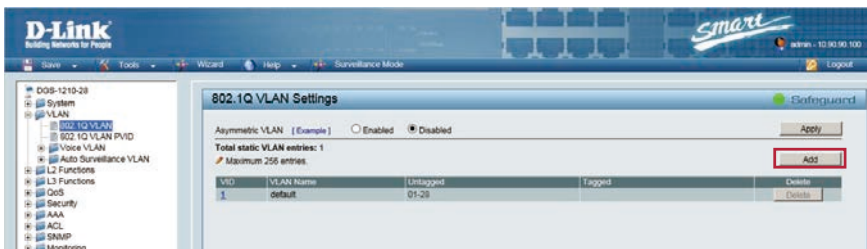
図 9-12 VLAN10 作成 (DGS-1210-28)
