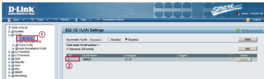
図 9-6 デフォルトVLAN指定 (DGS-1210-28)
