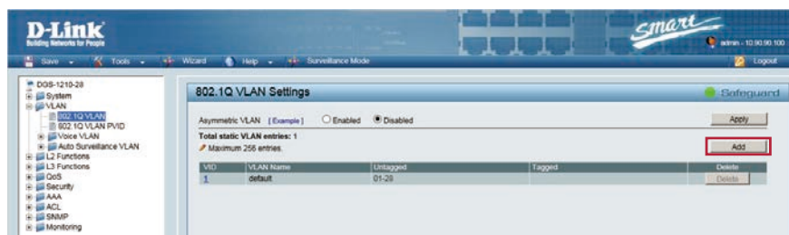
図 9-8 VLAN10 作成 (DGS-1210-28)
