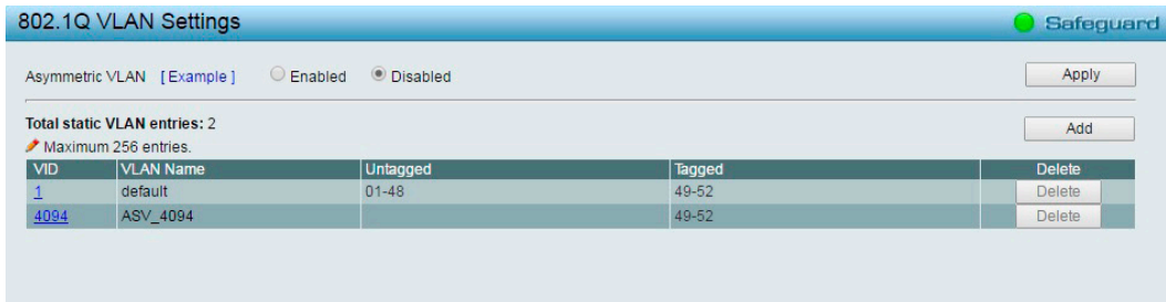
図 5-49 802.1Q VLAN Settings 画面
