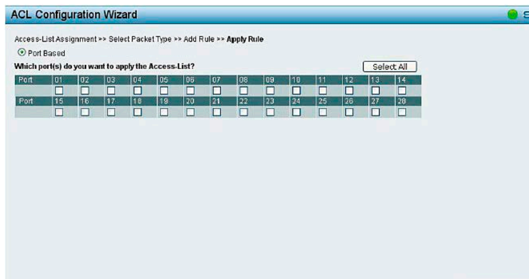
図 5-134 Add Access Rule – Ports 画面
