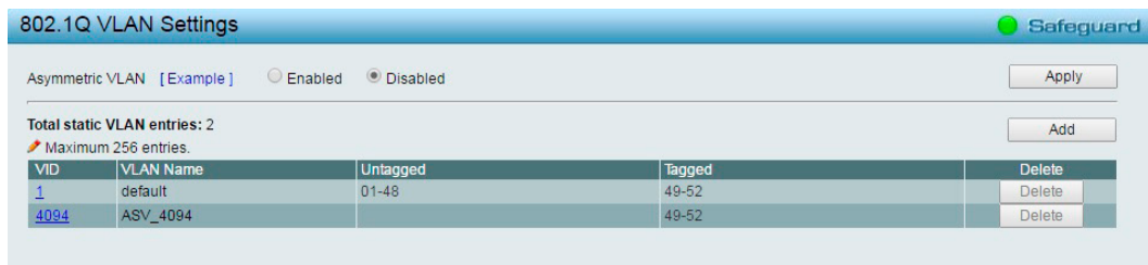
図 5-51 802.1Q VLAN Settings 画面
