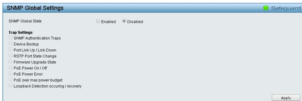
図 5-143 SNMP Global Settings 画面
