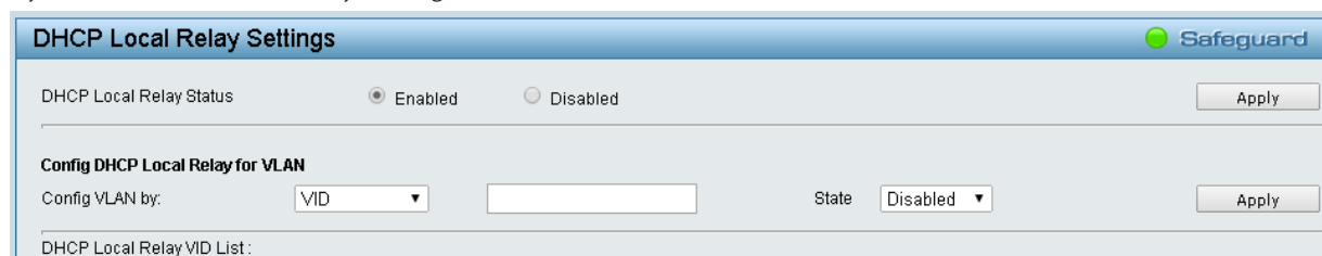
図 5-38 DHCP Local Relay Settings 画面
