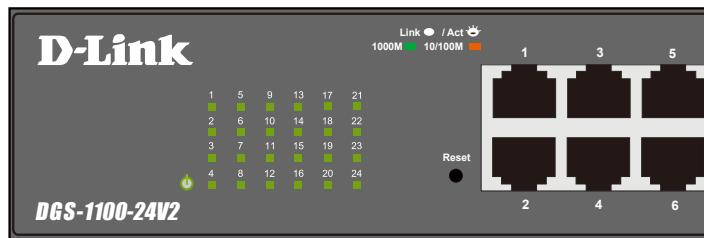
図 1-9 DGS-1100-24V2 の前面パネルの LED 配置図
