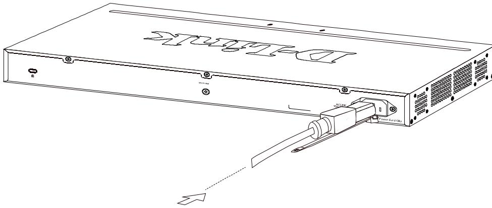
図 2-5 電源コード挿し込み
