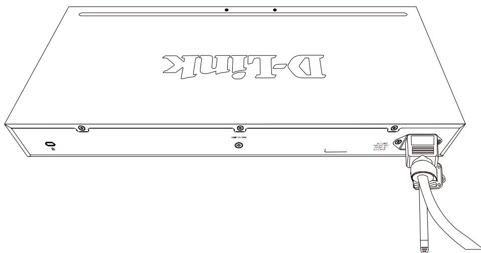
図 2-8 電源抜け防止器具の固定確認
