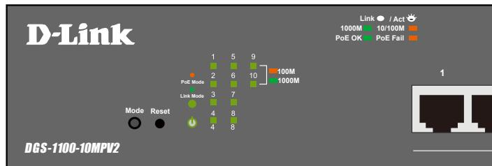
図 1-11 DGS-1100-10MPV2 の前面パネルの LED 配置図
