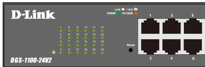
図 1-9 DGS-1100-24V2 の前面パネルの LED 配置図
