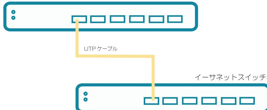
図 3-2 ストレート、クロスケーブルでハブまたはスイッチと接続する図
