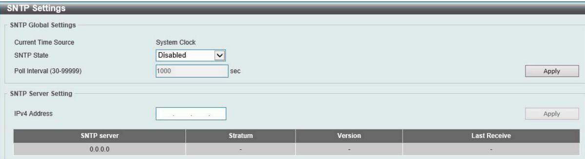
SNTP Settings 画面は、SNTP Global Settings と SNTP Server Setting の2つのセクションで構成されています。SNTP Global Settings では、Current Time Source (System Clock) を「Disabled」に設定し、Poll Interval (30-99999) を「1000 sec」に設定できます。SNTP Server Setting では、IPv4 Address に「0.0.0.0」が入力され、Apply ボタンが表示されています。
