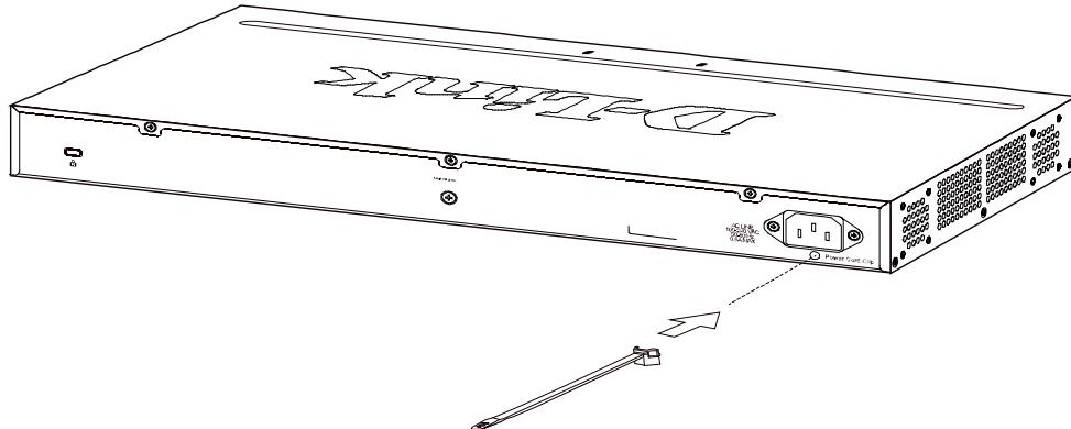
図 2-4 タイラップの挿し込み
