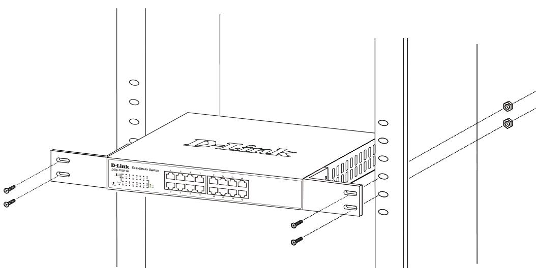
図 2-3 スイッチのラックへの設置
