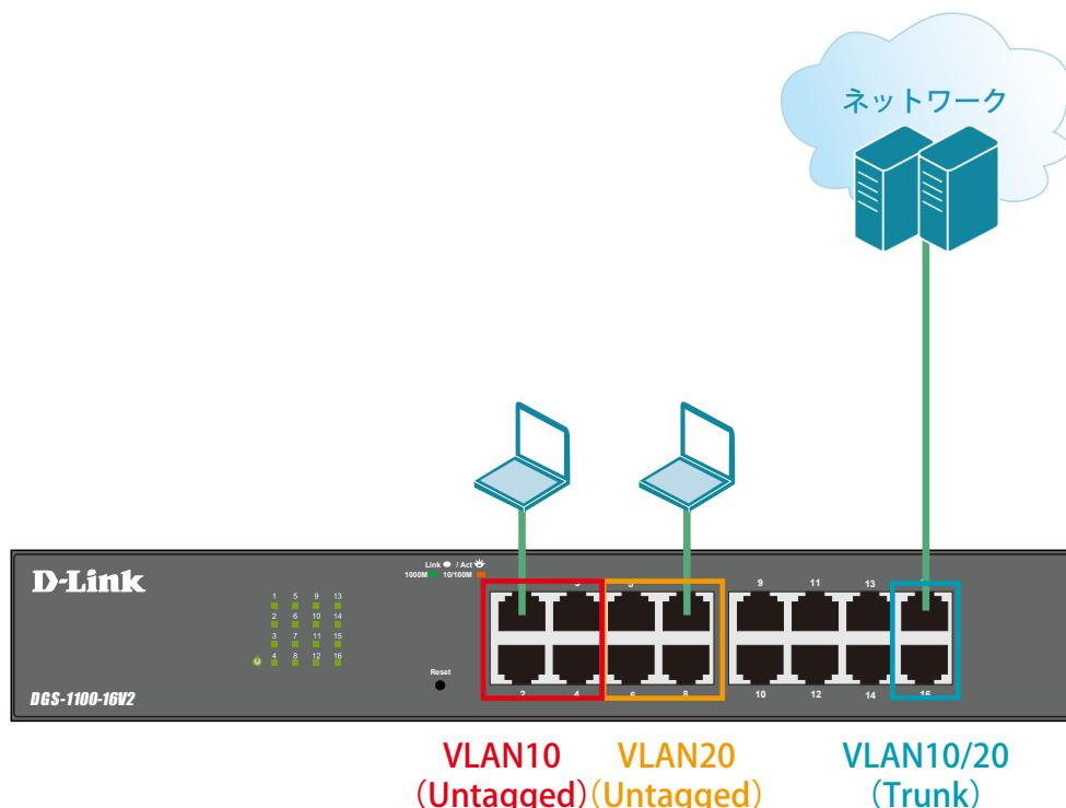
図 1-5 VLAN (DGS-1100-16V2)
