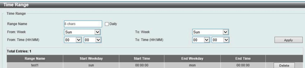
Time Range 画面は、Time Range の設定を行います。Range Name (8 chars) に「test1」を入力し、「Daily」を選択。From Week (Sun) と To Week (Sun) を選択。From Time (HH:MM) と To Time (HH:MM) ともに「00:00」を選択します。Total Entries: 1 の欄に「test1」と表示され、「Delete」ボタンが表示されています。
