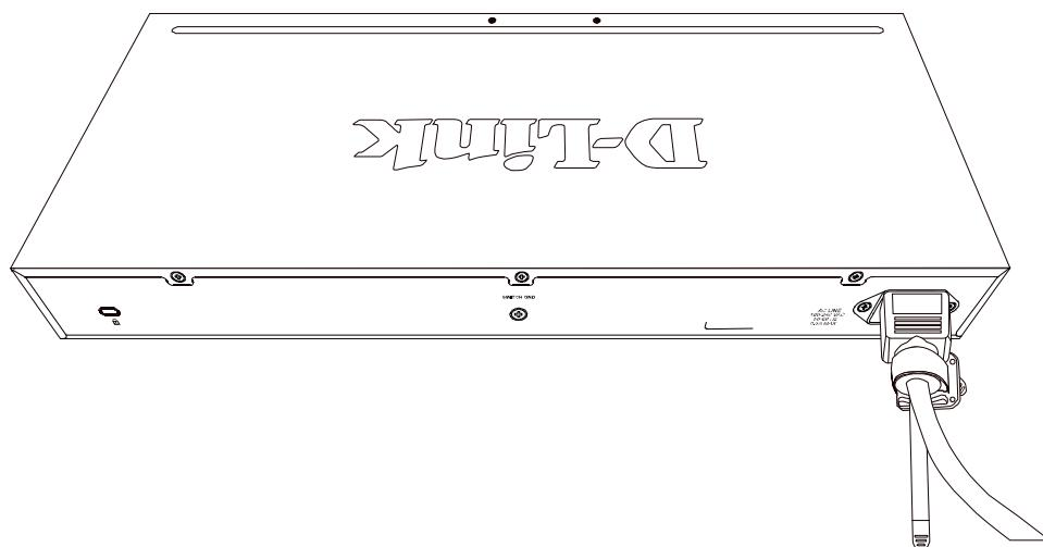
図 2-8 電源抜け防止クリップの固定確認
