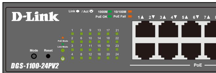
図 1-12 DGS-1100-24PV2 の前面パネルの LED 配置図
