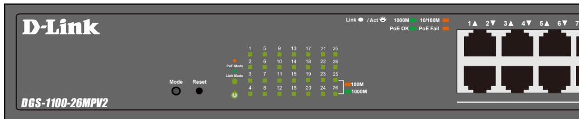
図 1-15 DGS-1100-26MPV2 の前面パネルの LED 配置図
