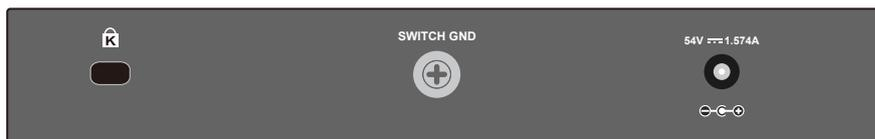
図 1-7 DGS-1100-08PV2 の背面パネル図
