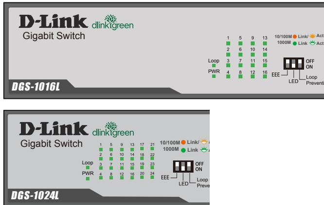
図 1-6 DGS-1016L、DGS-1024L の LED 配置図
