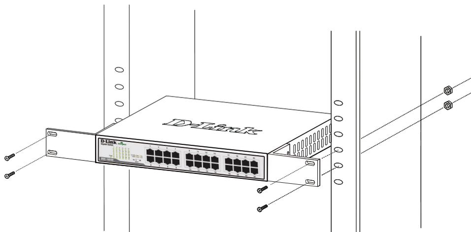
図 2-5 スイッチのラックへの設置
