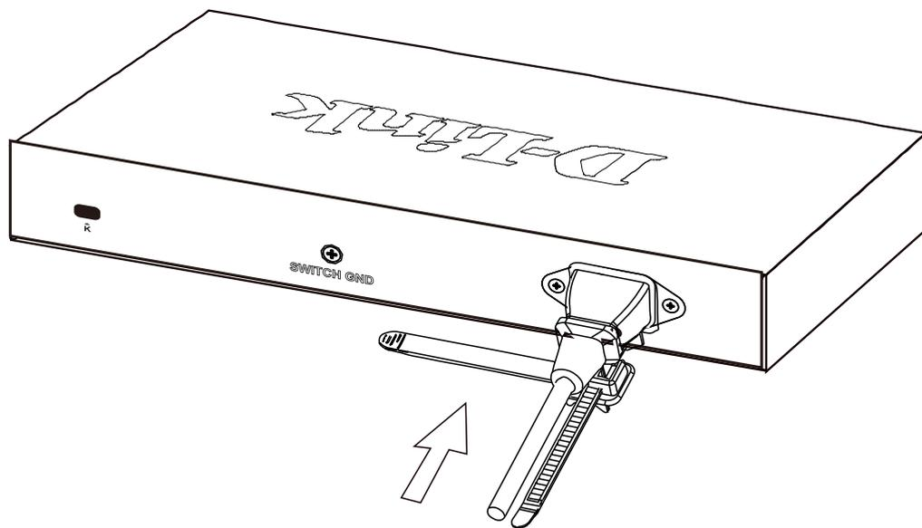
図 2-7 電源コード挿し込み
