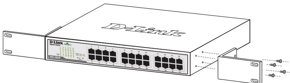
図 2-4 スイッチへのブラケットの取り付け
