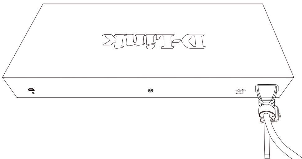
図 2-9 電源抜け防止器具の固定確認
