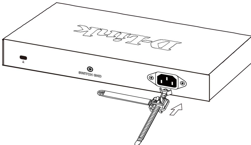
図 2-6 タイラップの挿し込み
