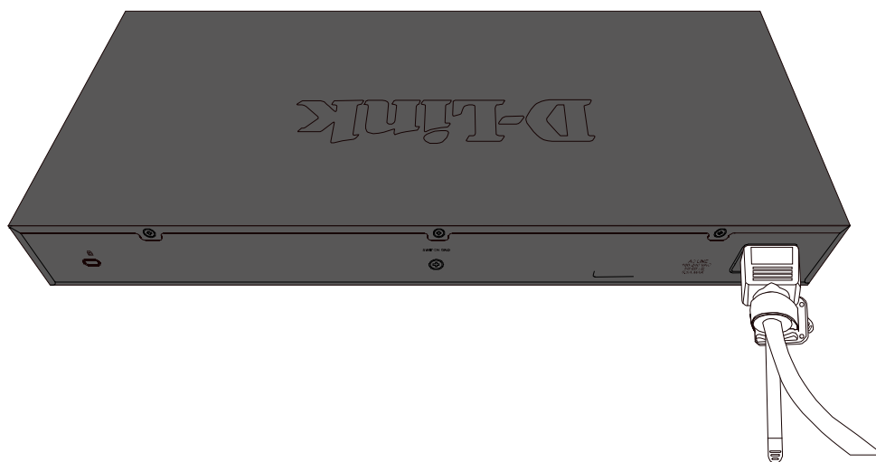
図 2-11 電源抜け防止器具の固定確認
