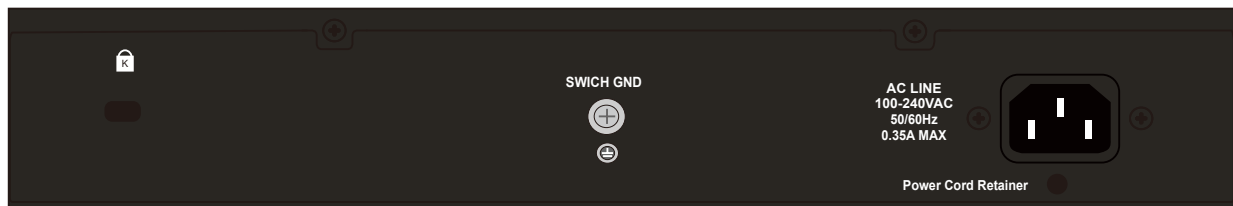
図 1-3 DGS-1016D の背面パネル図
