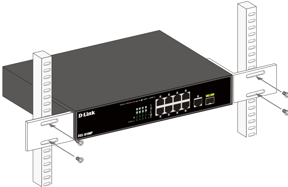
図 2-3 スwitchのラックへの設置
