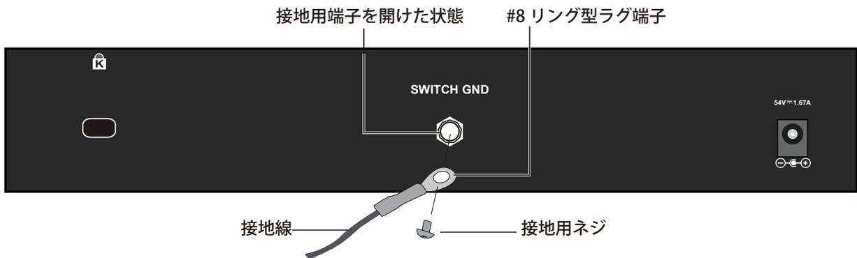
図 2-1 スイッチへのラグ端子の接地
