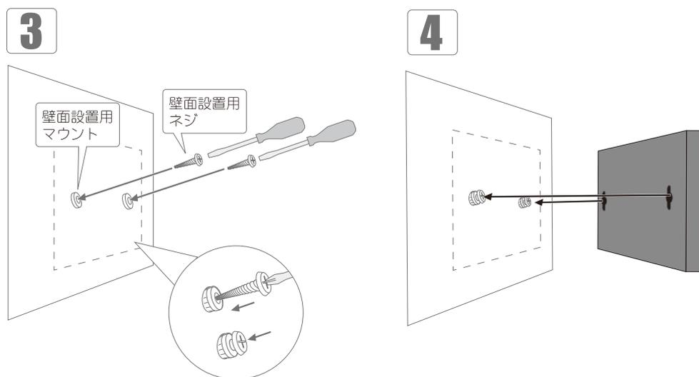
図 2-5 壁面へのネジと本体の設置
