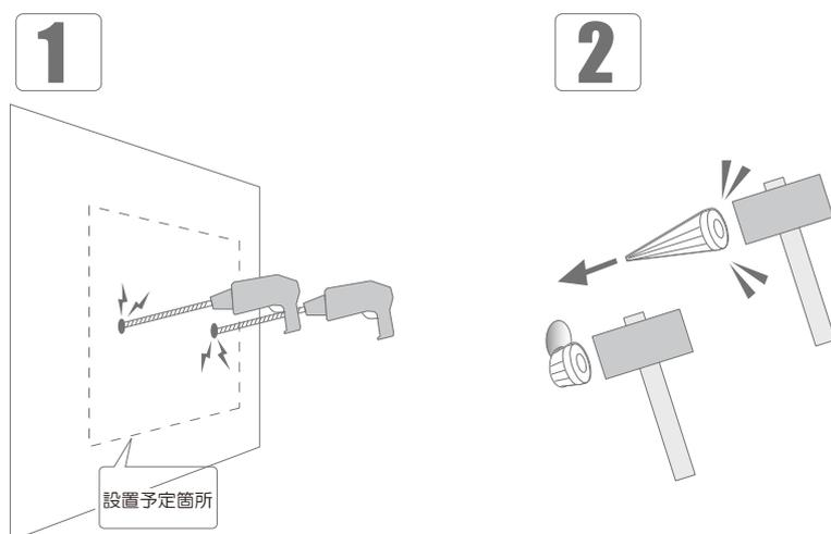
図 2-4 壁面へのアンカー設置
