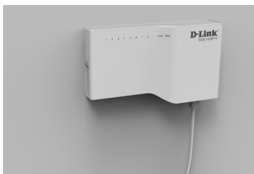
図 2-3 壁面へのネジと本体の設置
