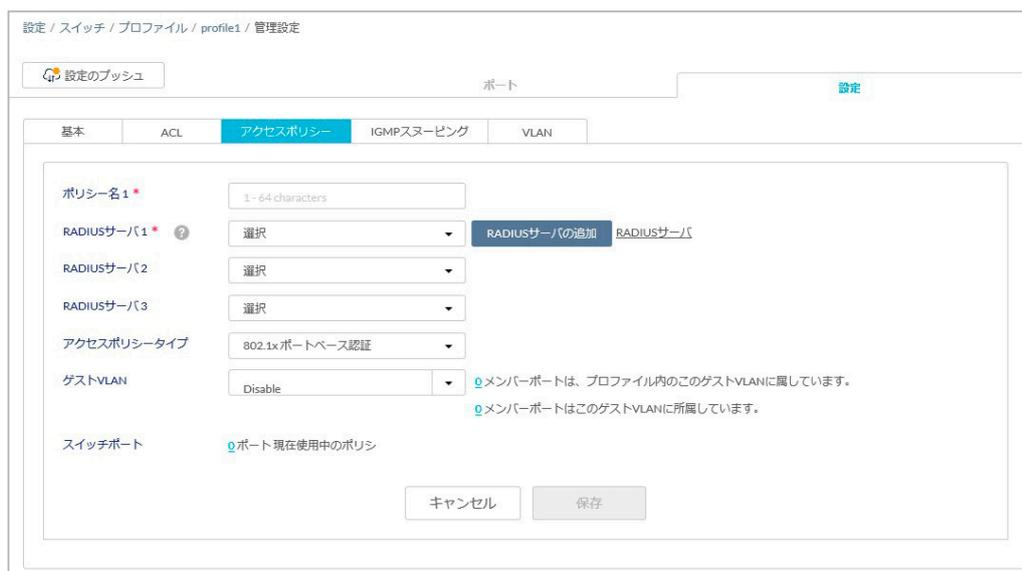
図 8-29 プロファイル - 設定 - アクセスポリシータブ
