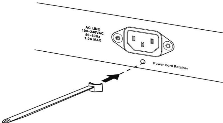
図 3-6 タイラップの挿し込み
