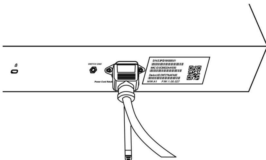
図 3-9 電源抜け防止クリップの固定確認
