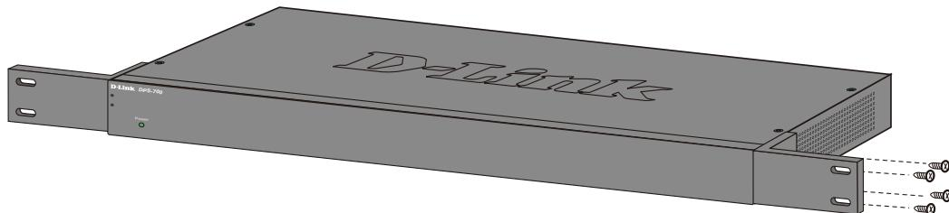
図2-3 DPS-700へのブラケットの取り付け
