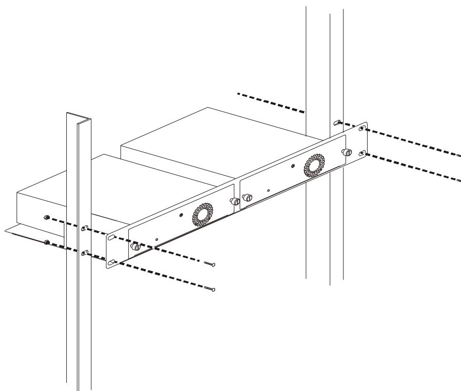
図 2-5 DPS-800 (DPS-200A/500A) のラックへの設置
