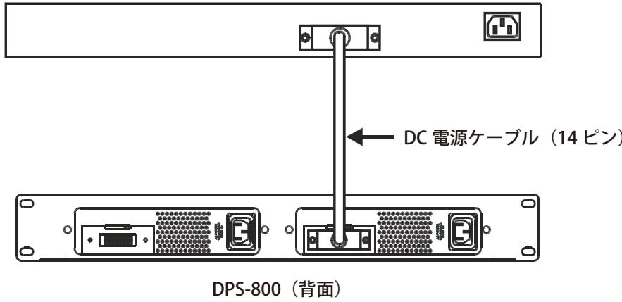
図 2-7 DPS-800 (DPS-200A/500A) とスイッチの接続
