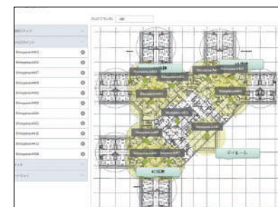
▲Nuclias Cloudに搭載されている機能の一つである、フロアプランの画面。地図の画像データを読み込んで、任意の場所に無線アクセスポイントの情報を配置できる
