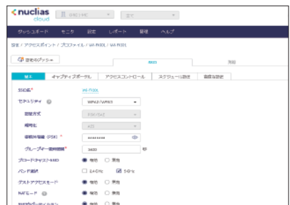
▲「Nuclias Cloud」の管理画面。無線APのプロファイル設定画面では、SSIDやSSIDのパスワードの変更、ブロードキャストSSIDやゲストアクセスモードのオン/オフなどが簡単にできる
