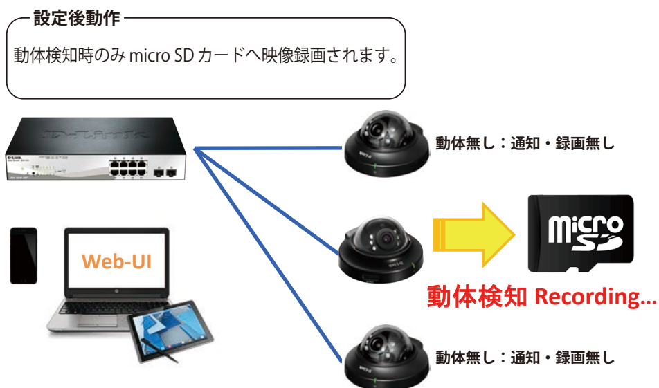
図 8-3 SD カードへの動体検知設定後の動作
