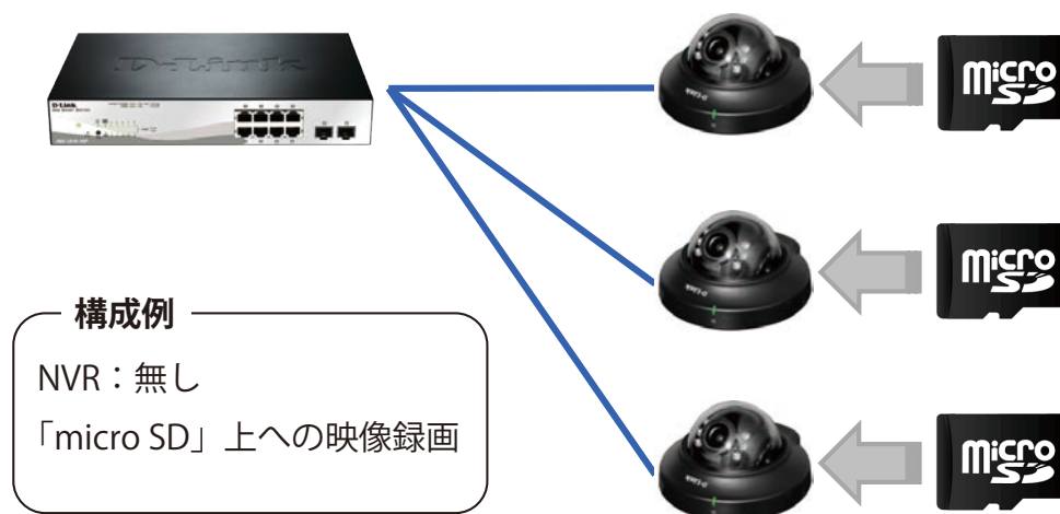
図 8-1 SD カードへの動体検知構成例
