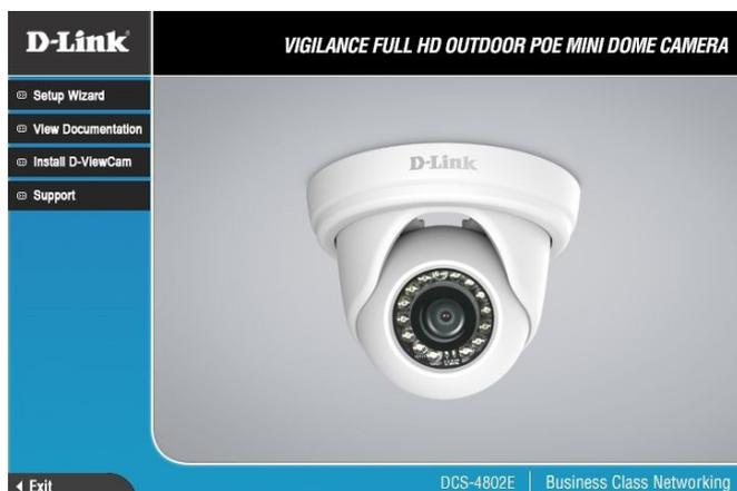
3. インストールが完了すると、Setup Wizardが起動します。Setup Wizard画面には、接続されているカメラのMACアドレスとIPアドレスが表示されます。DHCPサーバを使用していない場合、カメラの既定の固定IPアドレスは192.168.0.20です。カメラを選択し、[Wizard]ボタンをクリックします。
