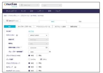
▲『Nuclias Cloud』の管理画面。無線APのプロファイル設定画面では、SSIDやPSKのパスワードの変更、ブロードキャストSSIDやゲストアクセスモードのオン/オフなどが簡単に行える
