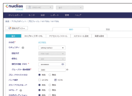
▲「Nuclias Cloud」の管理画面。無線 AP のプロファイル設定画面では、SSID や SSID のパスワードの変更、ブロードキャスト SSID やゲストアクセスモードのオン / オフなどが簡単にできる
