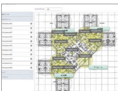
▲ Nuclias Cloud に搭載されている機能の一つである、フロアプランの画面。地図の画像データを読み込んで、任意の場所に無線アクセスポイントの情報を配置できる
