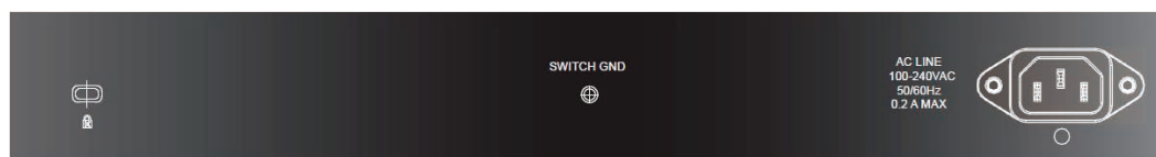
図 1-10 DES-1210-28 の背面パネル図
