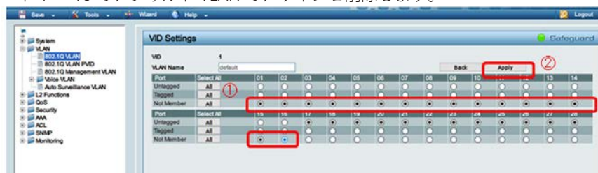
図 1-7 デフォルト VLAN アサイン削除 (DES-1210-28)
