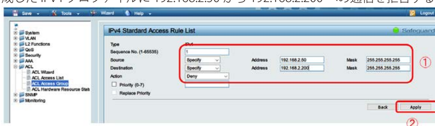
図 1-21 IPv4 プロファイルルール設定 (DES-1210-28)
