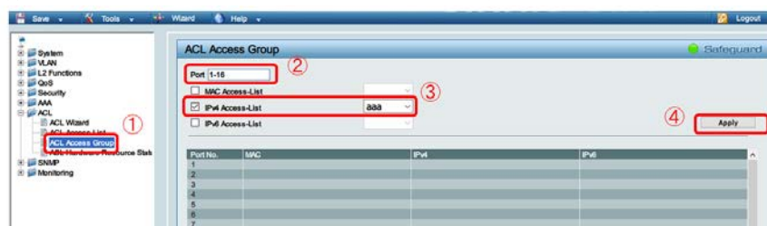
図 1-22 IPv4 プロファイルルール設定 (DES-1210-28)
